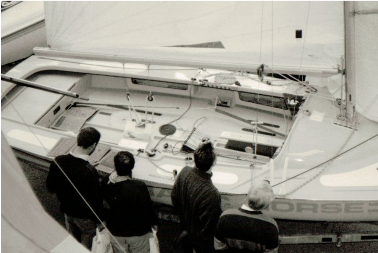
Foto: Magic Horse 2503 in 1990 nieuw op de beurs. Onderlijkstrekker van RVS draad de giek in, dan in de giek een rolletje om de kracht te verdubbelen en dan aan de voorzijde een lijn uit de giek aan SB naast de mast door het dek.
