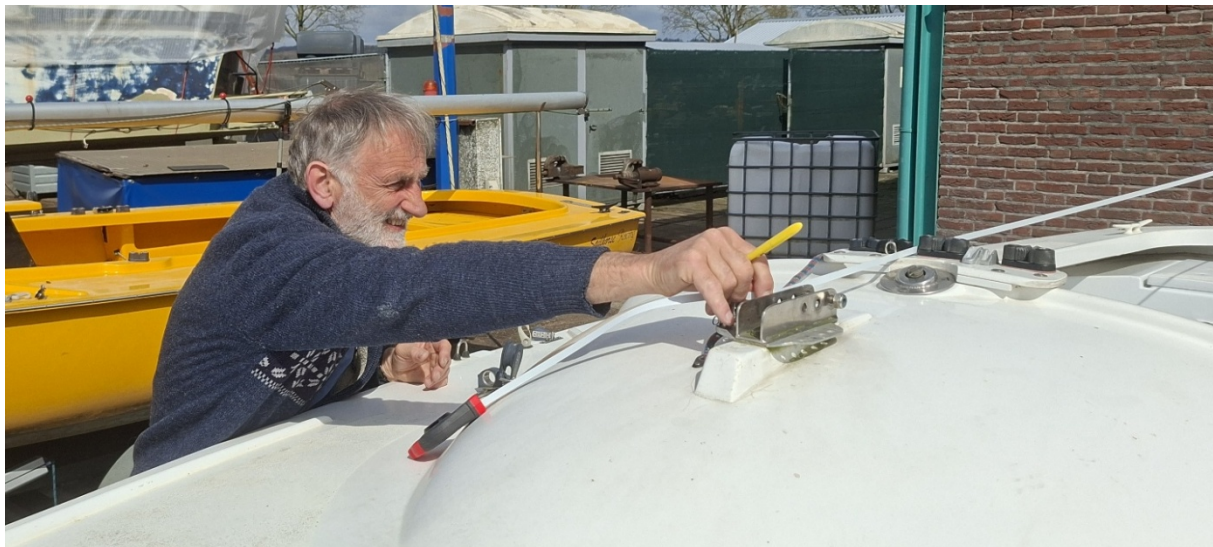
Foto vorige pagina: Verbondsmeter JJ Korpershoek meet de afstand van het 'rompnulpunt' (grofweg de spiegel) tot het achterste mastvoetgat te herleiden naar de achterkant van de mast).
