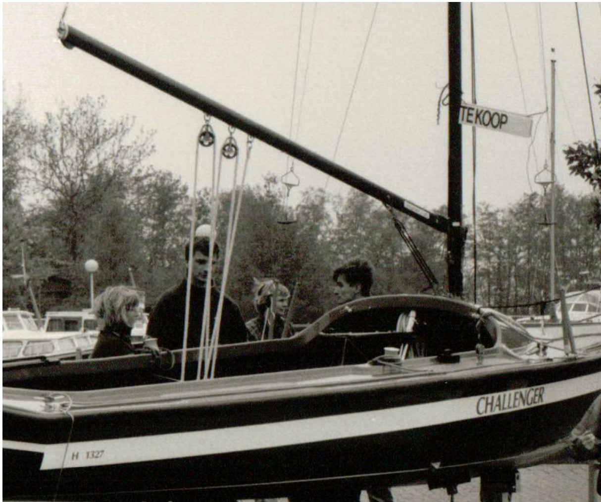
Foto: H1327 met rond-ovale giek, RVS eindkap met oog op de achterzijde
